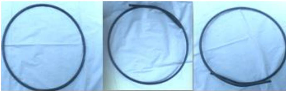
Gambar 4. Hasil uji coba pengerolan lingkaran besi roda traktor
