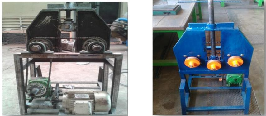
Gambar 2. Hasil Rancang Bangun Mesin Rol Besi Pejal
